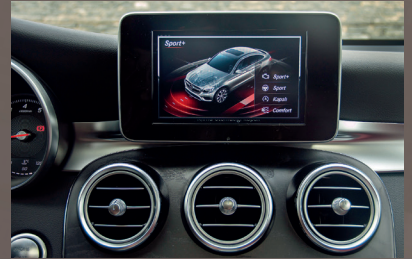
Kokpitin üstünde sonradan eklenmiş gibi duran merkezi bilgi ekranı bulunuyor. Dokunmatik olmayan ekranın çözünürlüğü iyi.
