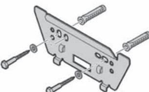
Cihazın duvara montajı, yandaki şekilde gösterilen ve cihaz ile birlikte verilen askı sacı ve vida-dübel seti kullanılarak yapılmalıdır.
