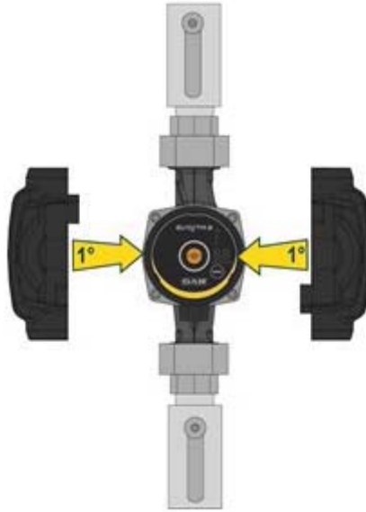
Resim 7: Pompa gövdesinin yalıtımı
