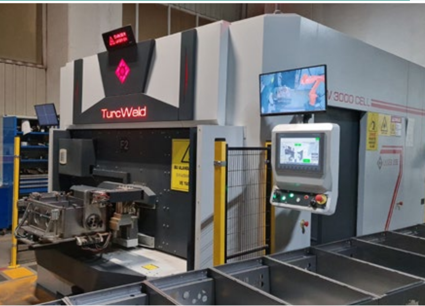
Kombi Gövde Robotik Lazer Kaynak Uygulaması
