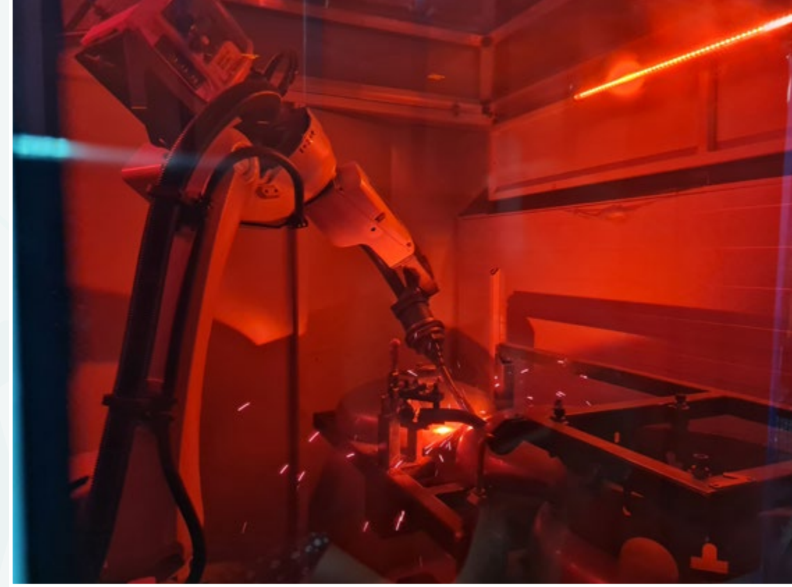
Boyler ve Termosifon Robotik Kaynak
